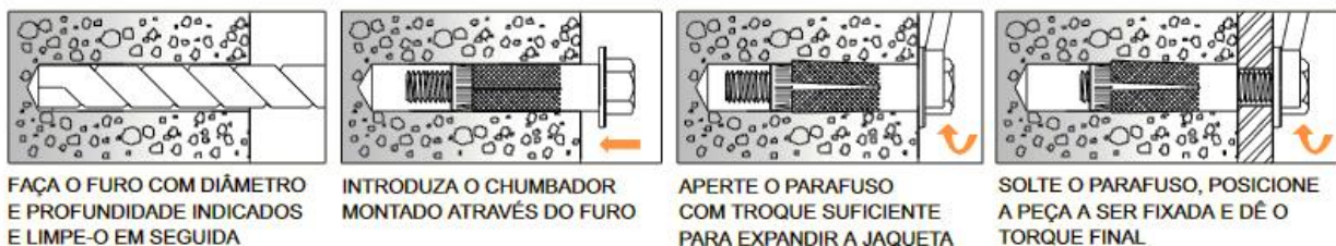
FIGURA 04: Ref. FIXAÇÃO CHUMBADOR DE EXPANSÃO
